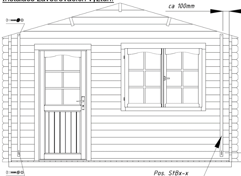
Instalace zavětrovacích výztuh:
